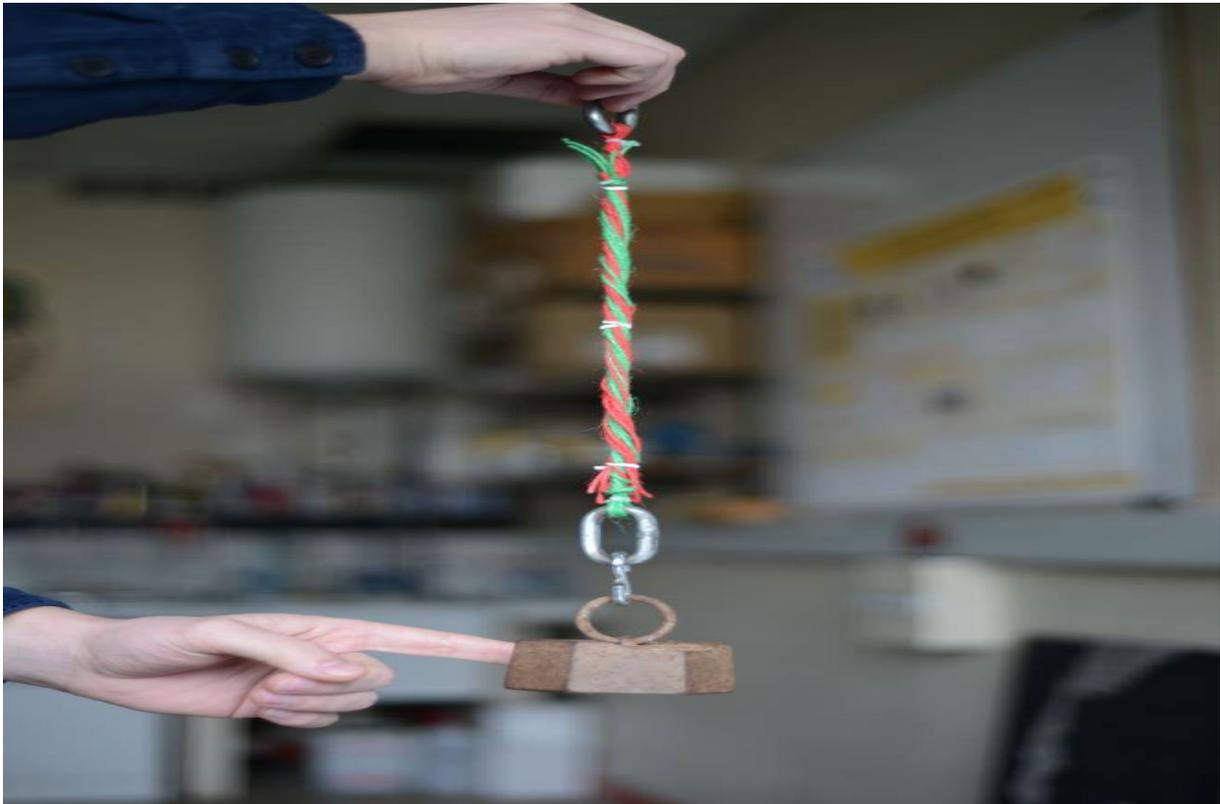
Expérience étudiant la solidité d'un assemblage de fils en fonction de la torsion. J. CRASSOUS
